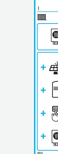
Lorsque l'installation se compose de différents appareils, ils doivent être mentionnés sur l'étiquette système. Les différents éléments (capteurs solaires, ballon solaire, etc.) sont désignés par des pictogrammes.
